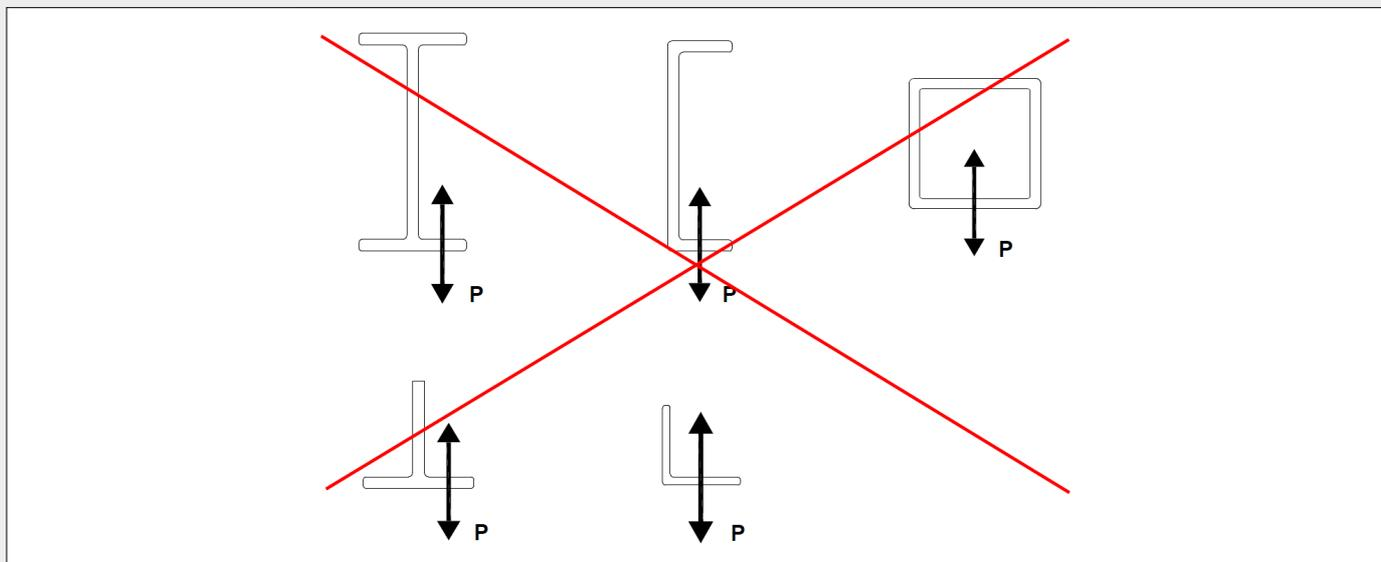
3. Qualora i profili siano fissati a parete e impiegati come sostegno perimetrale dei grigliati, assicurarsi che il grigliato sia posizionato quanto più in prossimità della parete, in modo che il peso sia scaricato sull'anima del profilo.
