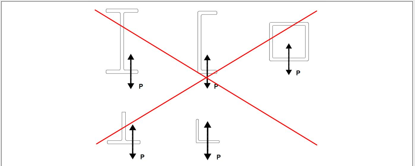
3. Wenn die Profile an der Wand befestigt werden und als umlaufende Auflage für die Gitterroste dienen, achten Sie darauf, dass der Gitterrost so nah wie möglich an der Wand positioniert wird, damit das Gewicht auf den Kern des Profils abgeleitet wird.
